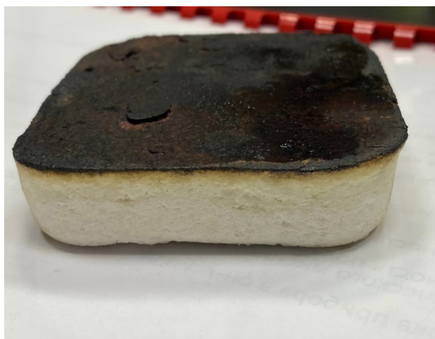
Рис. 17. Композитный материал на основе микрофибриллярной целлюлозы и грибкового меланина
